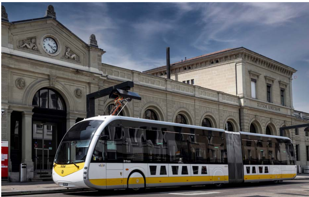
Der Elektrobus bei einer Schnell-Ladung seiner Batterie-Speicher
